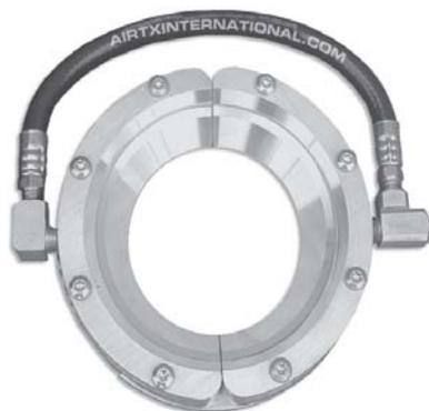
Gli asciugatori apribili danno un'amplificazione del getto di aria compressa di 25:1, e forniscono un grande flusso d'aria per raffreddare e asciugare prodotti in tutte le loro superfici. Il flusso circolare dell' Air Wipe™ fornisce quindi un forte flusso che circonda i prodotti, capace di rimuovere acqua e sporizia.
