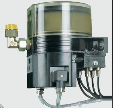
Tipo QLS 301 Grasso Tipo QSL 311 Olio Pompa per la distribuzione di grasso e olio fino a 200 bar controllo e gestione integrati
